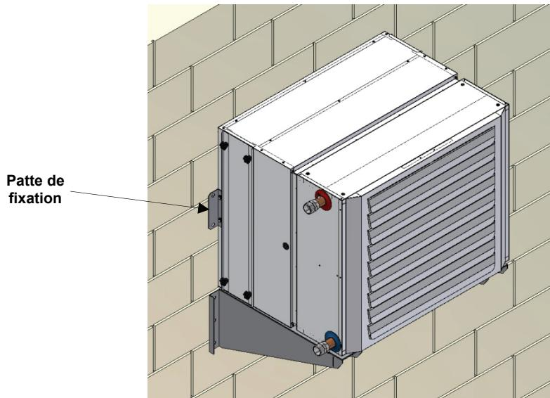
6. Terminer l'installation en s'assurant de la bonne étanchéité à l'eau et à l'air entre le caisson filtre et le mur sur la partie extérieure.
