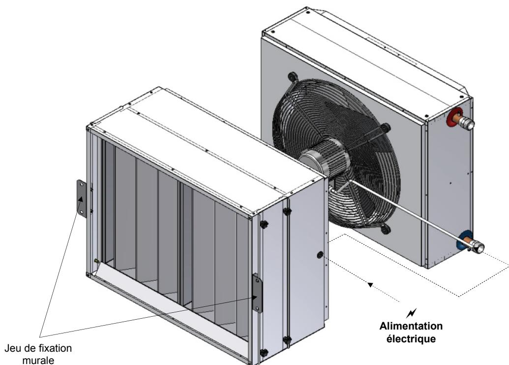
2. Positionner et assembler le **CAISSON FILTRE AIR NEUF** à l'arrière de l'aérotherme.
