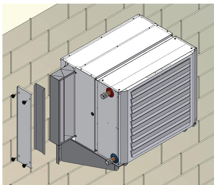
\* La fréquence de nettoyage dépend de la qualité de l'air aspiré. A noter qu'un filtre encrassé fait chuter les performances de l'aérotherme AZN.
