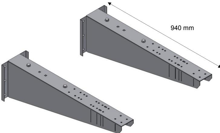
2. Positionner la 1<sup>ère</sup> console sur le mur et repérer les trous de fixation. Positionner la 2<sup>ème</sup> console en vous reportant au tableau page 3.
