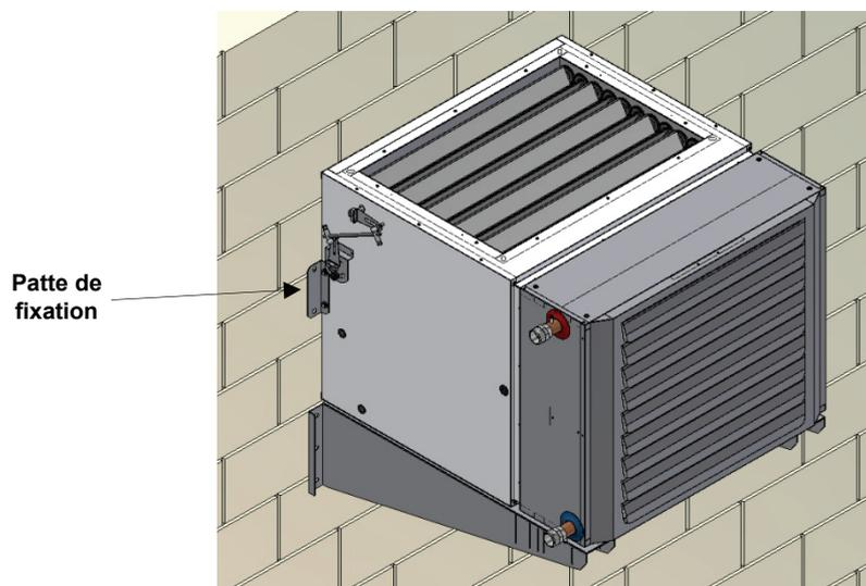
6. Terminer l'installation en s'assurant de la bonne étanchéité à l'eau et à l'air entre le caisson filtre et le mur sur la partie extérieure.
