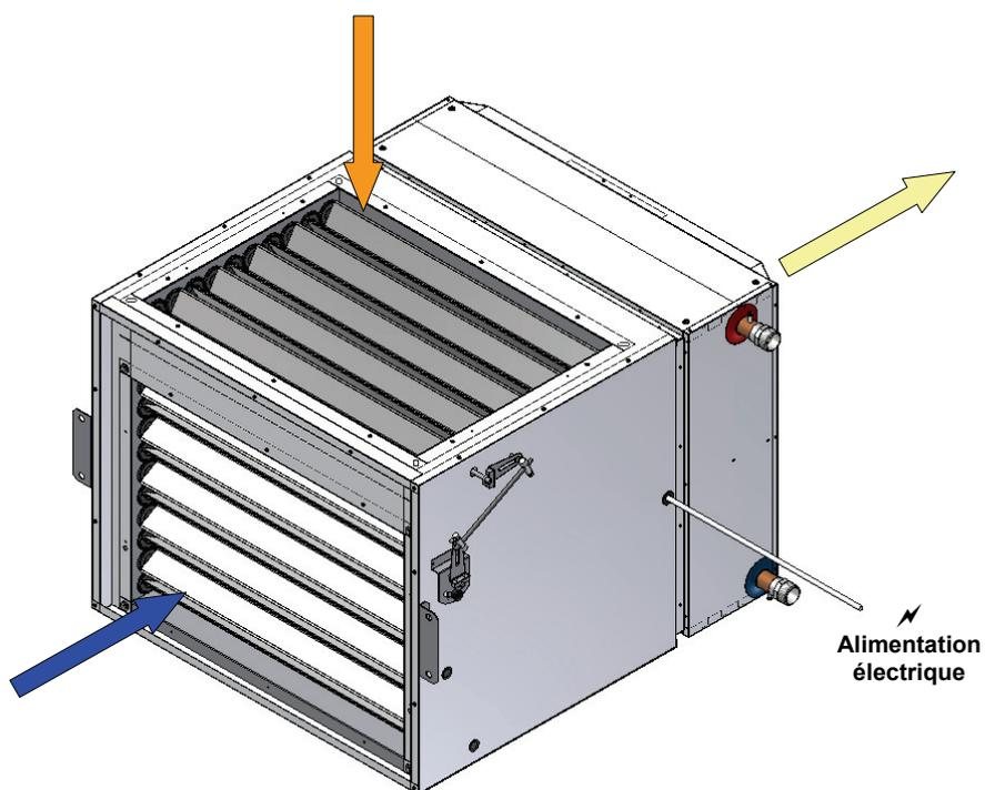
3. Fixer le **CAISSON FILTRE AIR NEUF** sur l'aérotherme en utilisant des vis auto-taraudeuse non fournies. Se servir des trous pré-perçés sur le caisson filtre.
