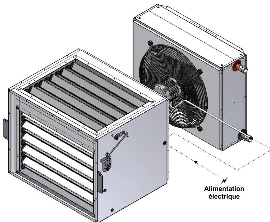
2. Positionner et assembler le **CAISSON DE MELANGE** à l'arrière de l'aérotherme.
