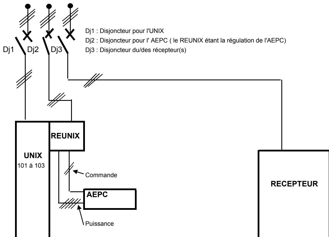
**Nota 1 :** La résistance d'appoint AEPEC doit impérativement être pilotée :
