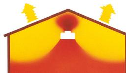
La montée en température du point haut du bâtiment déclenche son fonctionnement (grâce au thermostat intégré).
